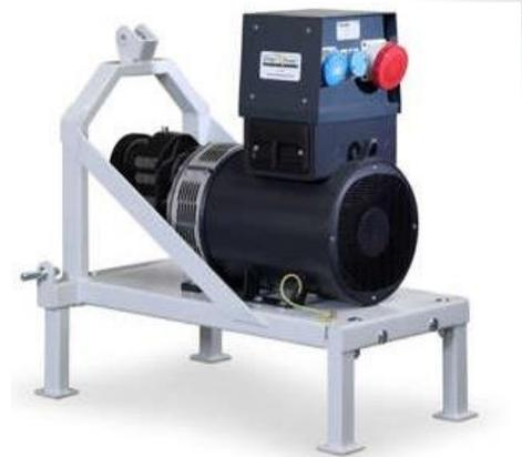
Monoblock-Einheit für Getriebe / Lichtmaschine, die durch eine Welle gekoppelt ist und auf einem geschweißten, pulverbeschichteten Grundrahmen aus Kohlenstoffstahl mit abnehmbaren Beinen installiert ist.
